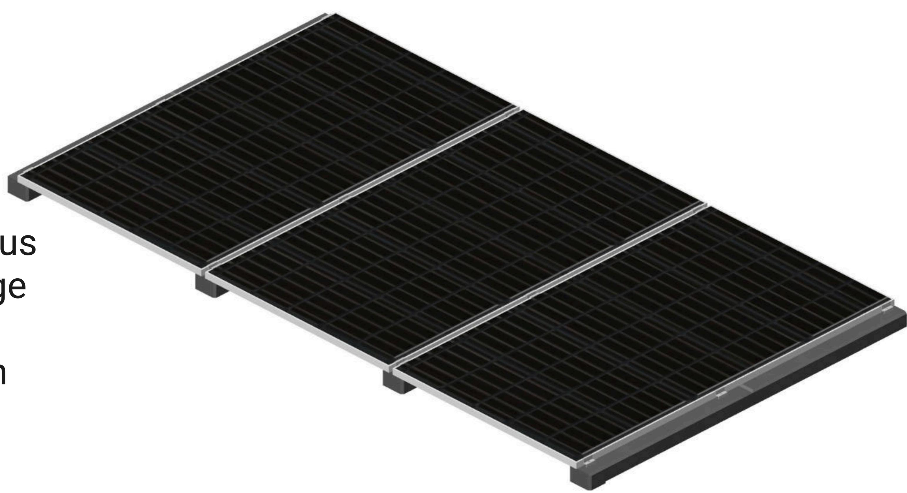
Der neue **Wattstone 0° V2** ist ein flacher Betonsockel aus feinem Sichtbeton zur einfachen und schnellen Montage von PV-Modulen - und dies ganz ohne Verletzung der jeweiligen Dachstruktur. Die PV-Module werden einfach auf den Betonflächen aufgelegt und mit PV-Modulklemmen (Mittel- oder Endklemmen) an den integrierten M8-Gewinden festgezogen. **Auch als kürzere Variante (0° Solo - 23 kg) erhältlich.**
